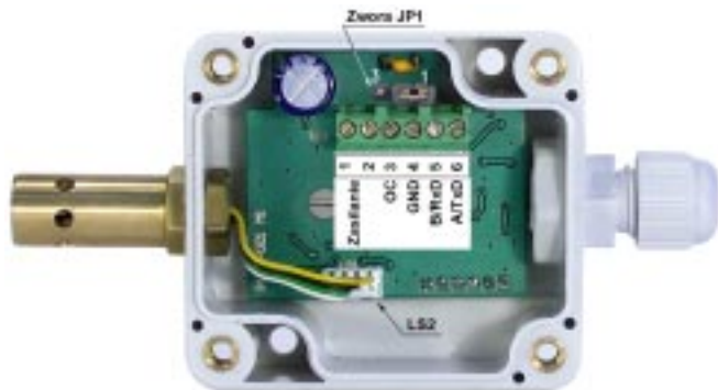
Rys.3. Sposób podłączenia sygnałów zewnętrznych.
