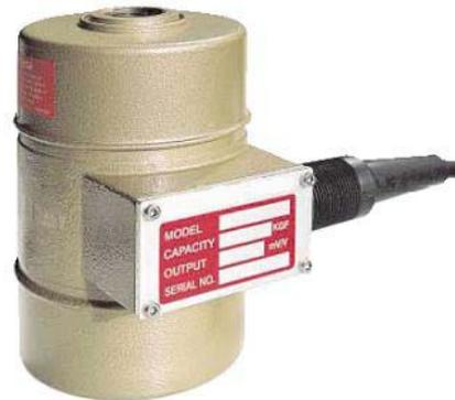
Die Serie ATR wurden für die Messung von Zuglasten bis zu 20 t in industriellen Anwendungen entwickelt, wo eine hohe Genauigkeit gefordert wird. Die robuste, hermetisch dichte Konstruktion aus hochfestem Werkzeugstahl garantiert eine sehr gute Reproduzierbarkeit bei einem hohen Ausgangssignal von 3 mV/V und geringem Messweg. Die einschlägigen Sicherheitsvorschriften bei der Installation von Zugkraftaufnehmern im direkten Kraftfluss (Einbau von Fanglaschen, Fangketten usw.) sind zu beachten!
