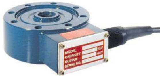
Die ADSCK-Scherkraftaufnehmer für Druck- und Zuglasten sind sehr flach und besonders für Präzisionsanwendungen geeignet, bei denen Platzprobleme und Seitenlasten auftreten. Alle Aufnehmer sind aus einem massiven Rohling aus Werkzeugstahl gefertigt und abgedichtet gemäß IP67.
