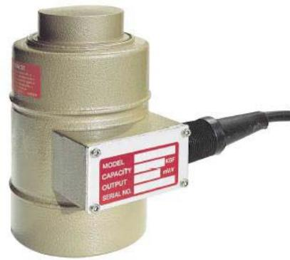
Bei den Wägezellen der Serie ACCDM/ACCCM handelt es sich um hermetisch dichte Kanister-Wägezellen für Drucklastmessungen bei hohen Messbereichen. Die Wegänderung bei Nennlast ist <0,2 mm. Die Zellen zeichnen sich durch eine robuste Bauweise und eine gute Genauigkeit aus, die auch unter harten Einsatzbedingungen erhalten bleibt.
