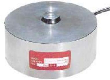
Die Druckkraft-Aufnehmer der Serie ACBES sind geeignet für präzise Kraft- und Gewichtsmessungen in den Messbereichen von 0...50 kg (0...500 N) bis 0...20 t (0...200 kN). Durch die relativ kompakte Bauweise eignen sich diese Aufnehmer für viele Anwendungen sowohl bei der Gewichtsmessung als auch bei der industriellen Kraftmessung. Die Aufnehmer sind hermetisch dicht und aus rostfreiem Stahl gefertigt. Die Krafteinleitung erfolgt axial über den integrierten Lastknopf.
