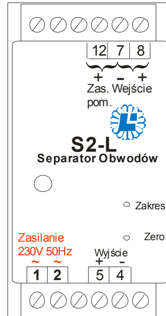
Opis zacisków oraz widok strony czołowej separatora 1 torowego
