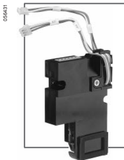
Moduł komunikacyjny instalowany w aparacie
