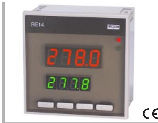
Mikroprocesorowy regulator RE14 jest przeznaczony do regulacji temperatury lub innych wielkości fizycznych np. ciśnienia, wilgotności, poziomu przetworzonych na sygnał elektryczny. Wyświetla wartość mierzoną, wartość zadaną i wartość sygnału wyjściowego. Regulator ma wyjścia ciągłe i dwustawne. Interfejs RS485 z protokołem MODBUS lub LUMBUS umożliwia pracę w systemach komputerowych.
