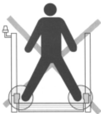
Rys. 1: Czujniki leżące naprzeciw siebie nie mogą być aktywowane równocześnie.
