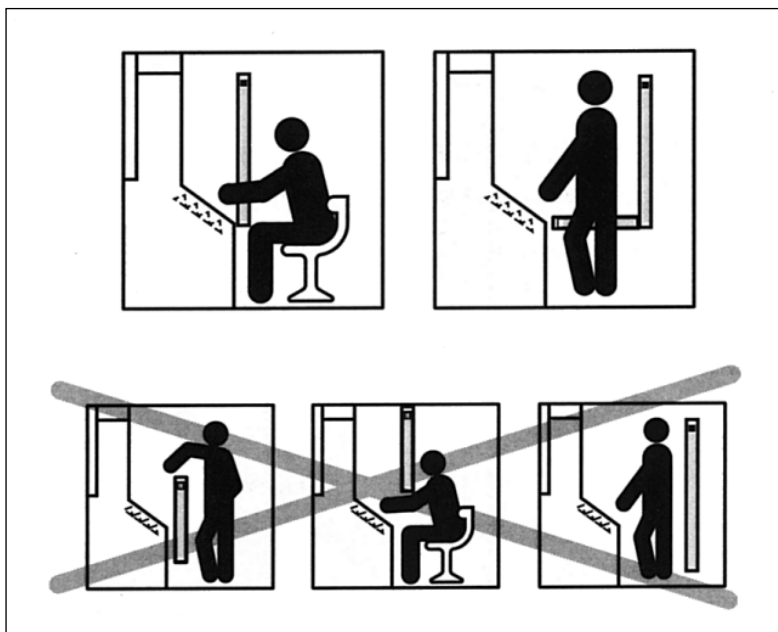
Rys. 2-2: Montaż C 2000: wykluczenie możliwości ominięcia z góry, z dołu, z boku lub pozostawania w przestrzeni między strefami zagrożenia a wykrywania
